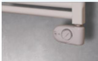
Resistenza elettrica a connettore 4 poli con termostato elettronico per regolare la temperatura del fluido interno. Classe di isolamento I. Grado di protezione IP44. L'elettronica è fornita in colore Bianco Standard (cod. 01) per radiatori bianchi; cromata per radiatori colorati.
